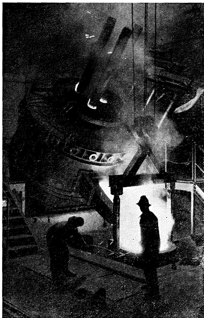
Električna peč je odprta, iz nje teče visokokvalitetno jeklo
