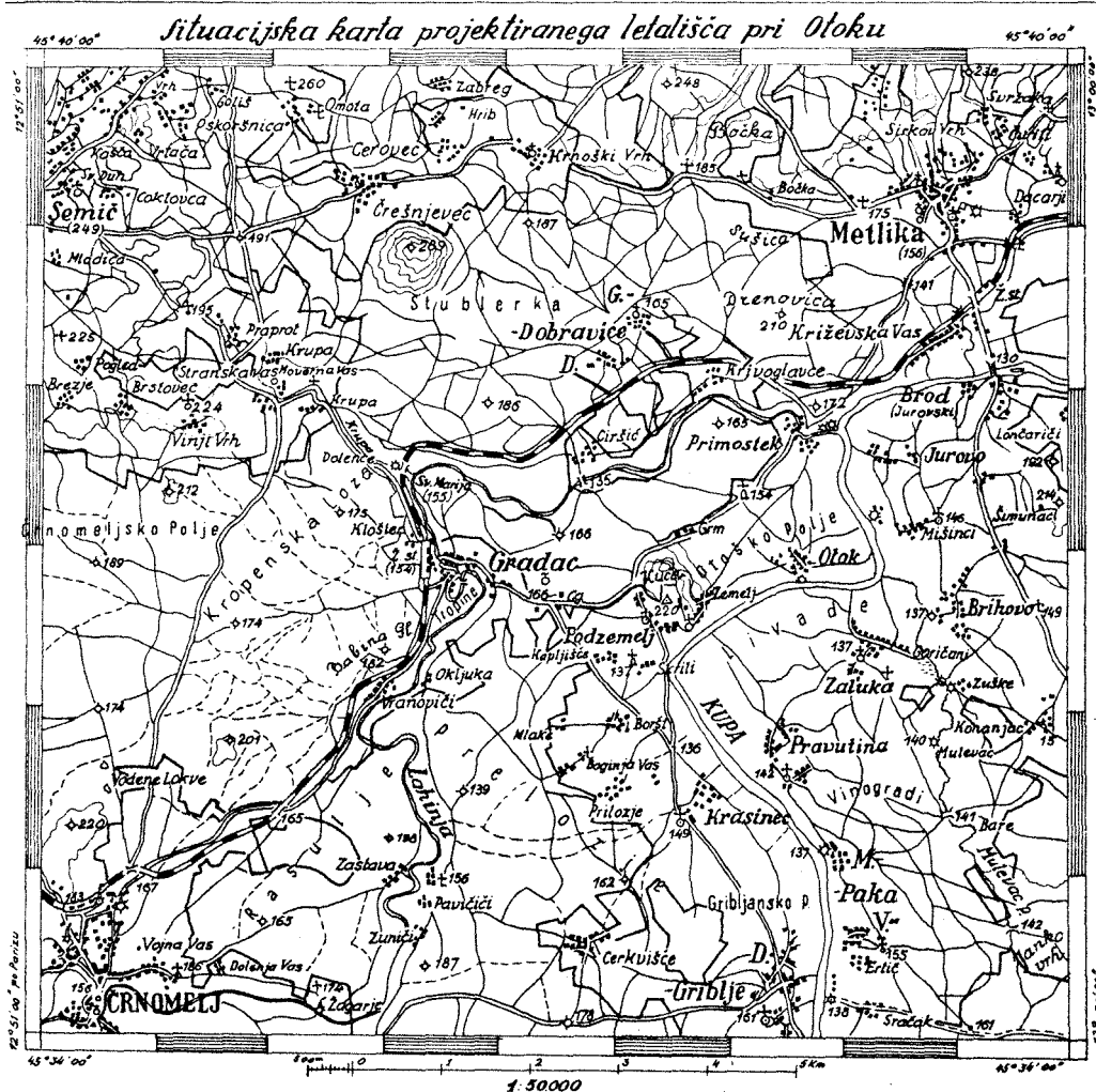
FAKSIMILE SITUACIJSKE KARTE PROJEKTIRANEGA LETALIŠČA PRI OTOKU V BELI KRAJINI, IZDELANE V MERILU 1 : 50.000 V GEODETSKI SEKCIJI GLAVNEGA ŠTABA NOV IN PO SLOVENIJE. K TEJ SITUACIJSKI KARTI SO GEODETI GLAVNEGA ŠTABA IZDELALI SE DETAJLNA TALNA NAČRTA LETALIŠČA V MERILIH 1 : 10.000 IN 1 : 5000
