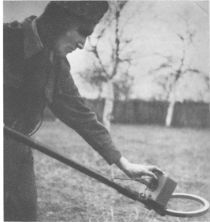
Инжињеријске јединице 1. армије биле су опремљене минодетекторима за откривање непријатељских минских поља (из фототеке „Борбе“)
