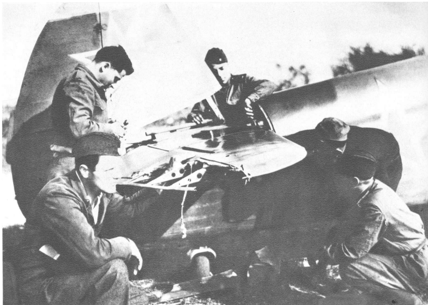
Авио-механичари врше поправке на репу ловачког авиона ЈАК-1 који је оштетила непријатељска противавионска артиљерија на сремском фронту (из Музеја Југословенског ваздухопловства)
